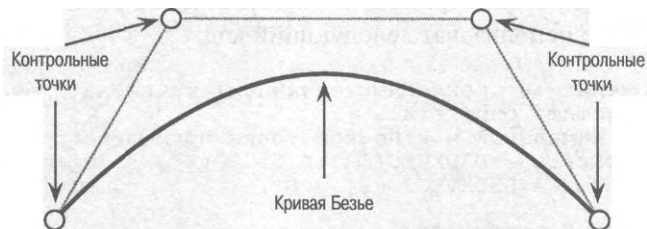
Рис. 2.3. Кубическая кривая Безье использует четыре точки для определения направления движения от начала к концу
