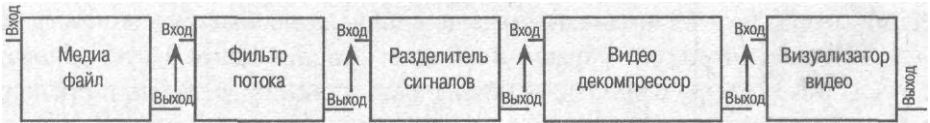
Рис. 14.3. Демонстрационный набор из четырех фильтров используется для получения данных медиа файла, их декодирования и визуализации
