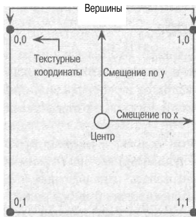
Рис. 12.5. При использовании вершинного шейдера частица состоит из четырех вершин, определяемых центральной точкой, смещением от центра, рассеянным цветом и текстурными координатами
